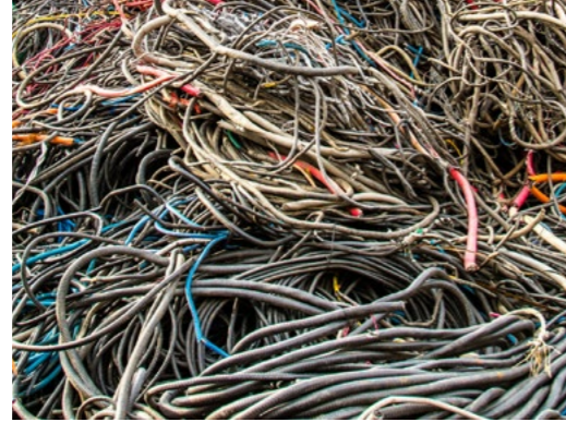
N°2 copper cables
